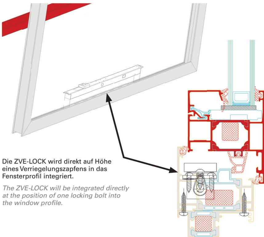
Die ZVE-LOCK wird direkt auf Höhe eines Verriegelungzapfens in das Fensterprofil integriert.
