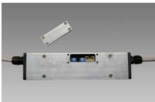
Der EA-L 100-180 verfügt über eine externe Abschaltung mit zusätzlichen Einstellmöglichkeiten für Kraft und Strom.
