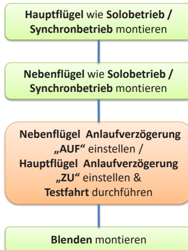
Abbildung 10: Montager Reihenfolge STULPFLÜGEL Montage
